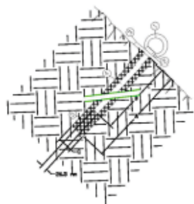
Particolare A Esempio di Sistema di Ancoraggio per Rete Parasassi
